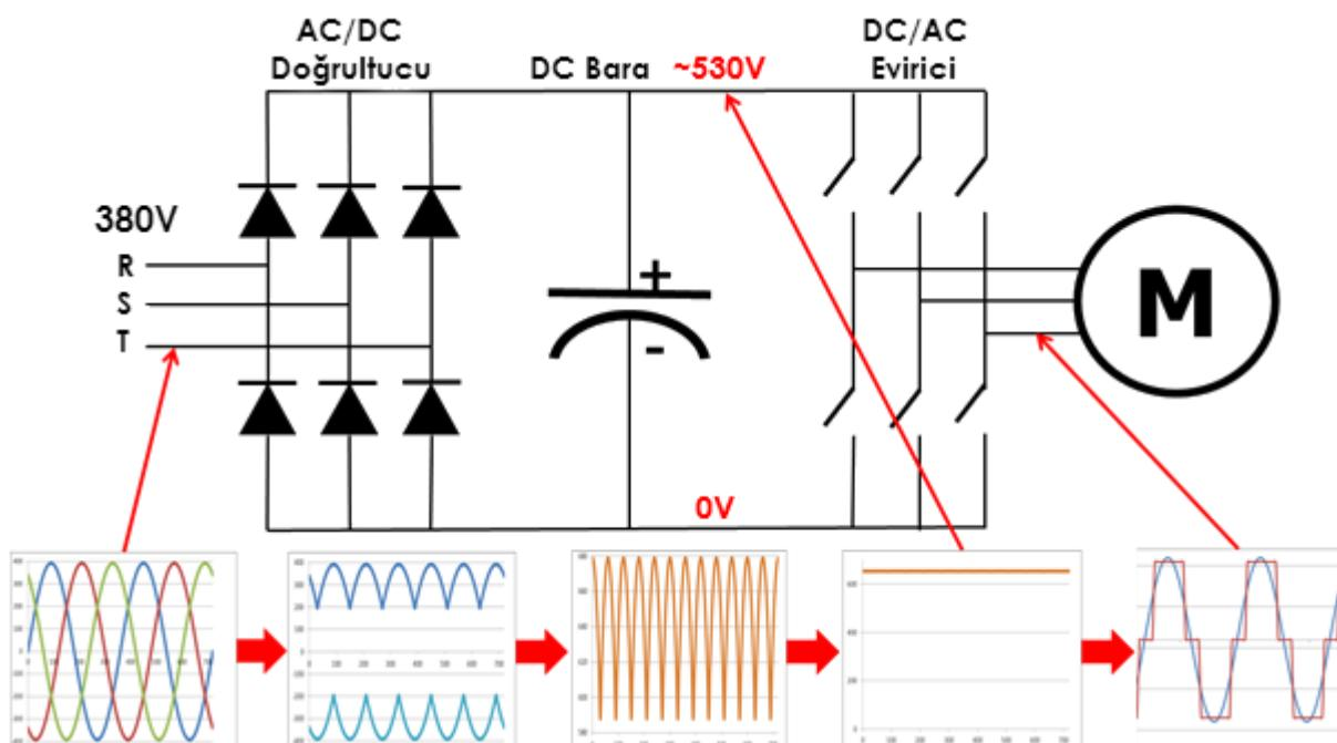
Yukarıdaki resimde görüldüğü gibi diyonotlar tarafından doğrultulan gerilimin dalga şekli tam olarak düz değildir. DC gerilimin dalga şeklini düzeltmek için kondansatör kullanılır ve kondansatör ile düz bir DC gerilim elde edilir.
