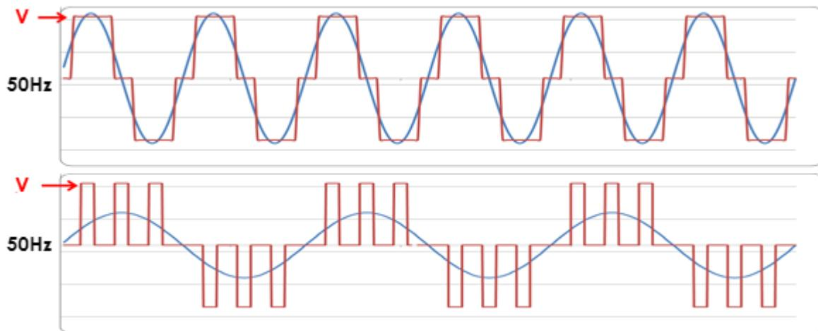
Darbe genişlik modülasyonu (PWM) yöntemiyle oluşturulan AC gerilim frekansı ve gerilim kontrolü ile motorun hızını kontrol ederek istenilen hızda motorun çalışmasını sağlar.
